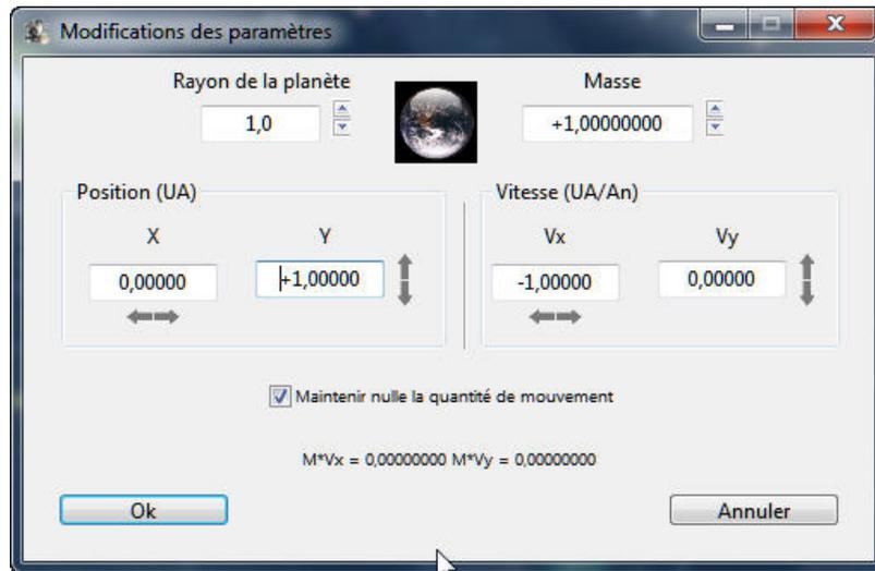
FIGURE 6 – **Dialogue Modifications des paramètres.** On peut modifier la **masse**, la **position** et la **vitesse** de la planète. Si la case **Maintenir nulle la quantité de mouvement** est cochée, cette propriété est conservée. On peut également modifier le rayon de la planète, c’est un paramètre purement esthétique qui n’a aucune influence sur le calcul.
